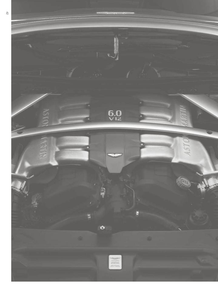
一辆高品质跑车需要一台性能卓越的发动机一一 它是任何高品质跑车的灵魂。阿斯顿·马丁 DB9 采用的是铝质 6.0 升 V12 型大功率发动机。它的 输出功率为 350 kW (470 bhp),输出扭距为 600 Nm (443 lb ft)。动力重量比为 199 kW/公吨 (267 bhp/吨)——在同类发动机中遥遥领先。
